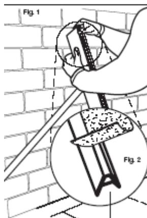
3. Iniziare applicando la fibra al telaio avendo cura di allineare perfettamente la fibra al bordo (vedi dettaglio nella figura sopra).
